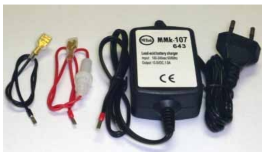
MMK-107 CARGADOR DE BATERIAS 107 A 1.2A 12V
